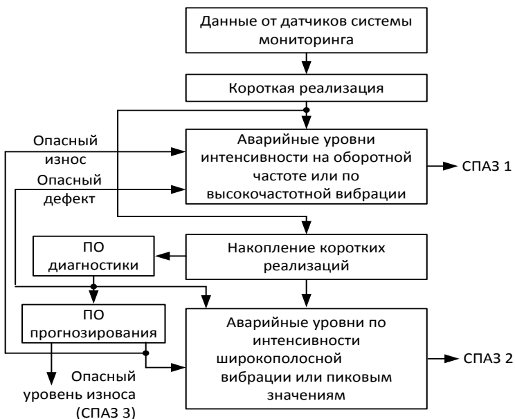
Рис. 2 – Структура сбора данных для системы противоаварийной защиты
